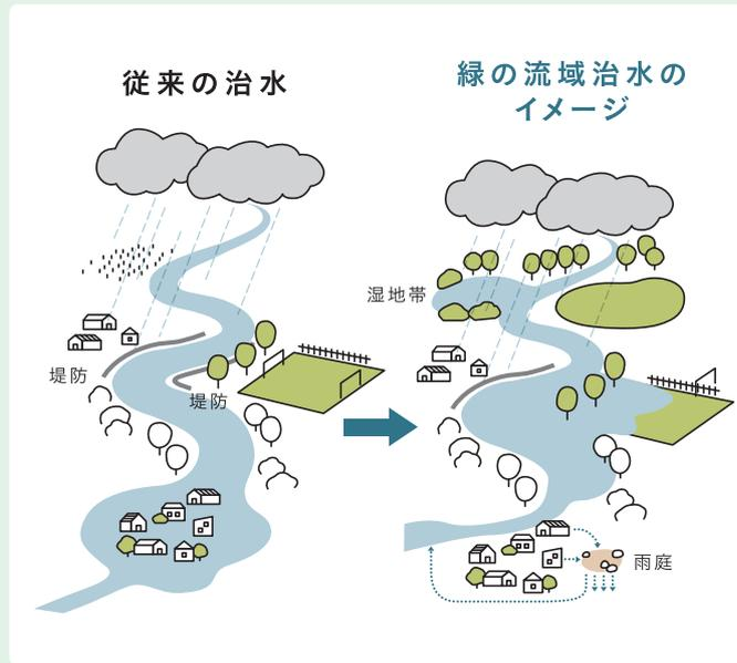
流出抑制対策には、貯留、浸透、蒸発散の増加、流速の低減などの手法があります。図のように地表に水を貯める、土地や砂利の中に水を貯める、地下に浸透させるなどの手法を組み合わせることによって大きな効果を発揮します。また、樹木の枝葉、幹、落葉などによって降雨が遮断され、豪雨時においてもかなりの雨水が地表面に到達する前に保水されると言われ、最終的には空气中に蒸発して流出しません。流速の低減により洪水の量が減ることは知られていますが、今後の研究課題でもあります。
